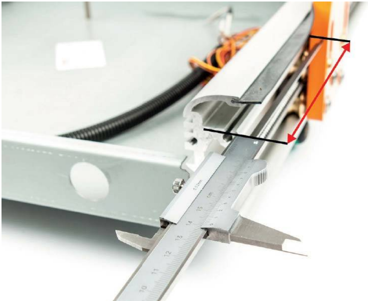
Fig. 2.72 Aligning the gantry
