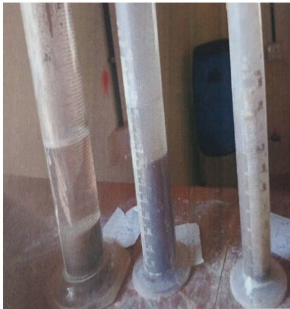
Fig. 2 Bleeding test setup
