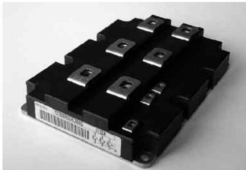
Fig. 6.27: IGBT 1200A, 3300 V (Infineon-EuPEC)
