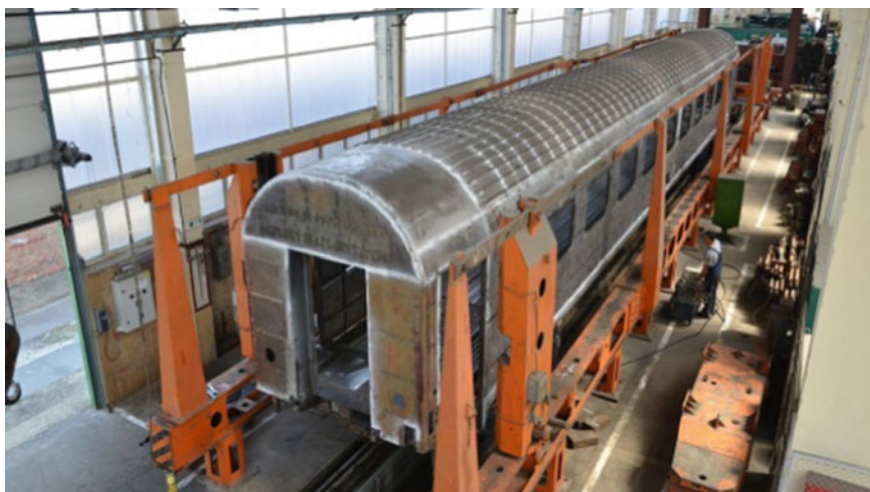
Fig. 9 Strength test of carbody (Photo: Sándor Czeglédi)
